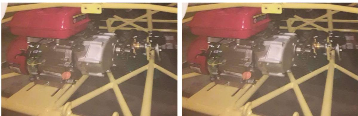
Rapport de transmission: pignon de 11 dents à l'avant et couronne de 54 dents à l'arrière, entraînés par une chaîne. Tandwielperhouding: 11 tanden voor en 54 tanden achter, aangedreven door een ketting.
